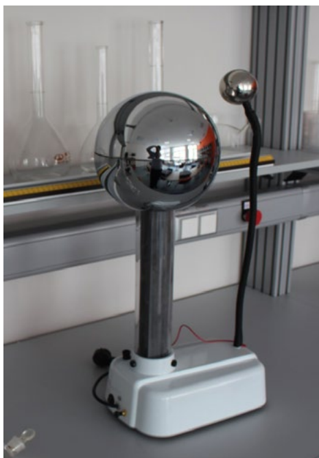
Рис. 3. Генератор Ван де Граафа
